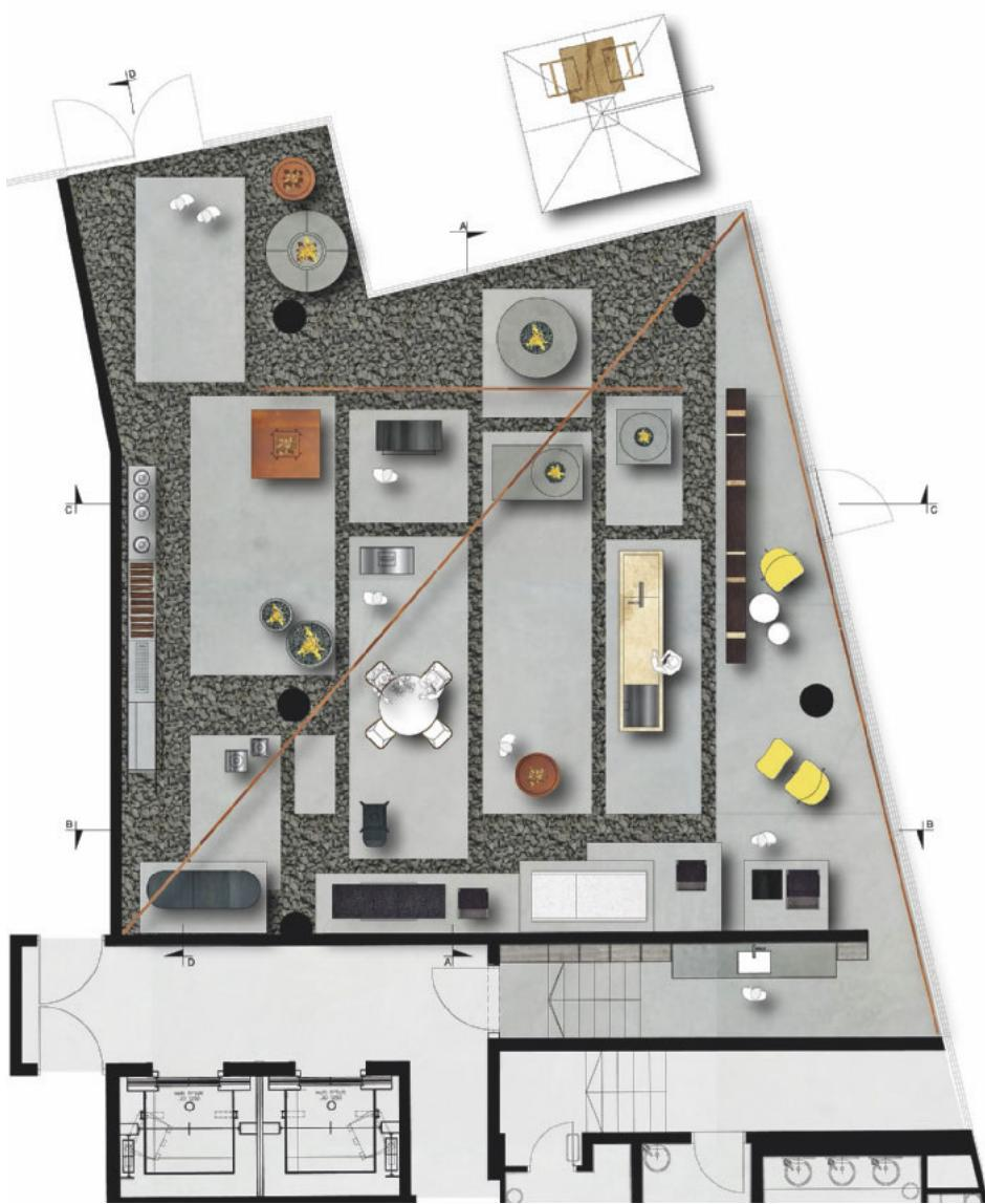
Grundriss mit eingezeichnetem Verlauf der Stahlprofile.
